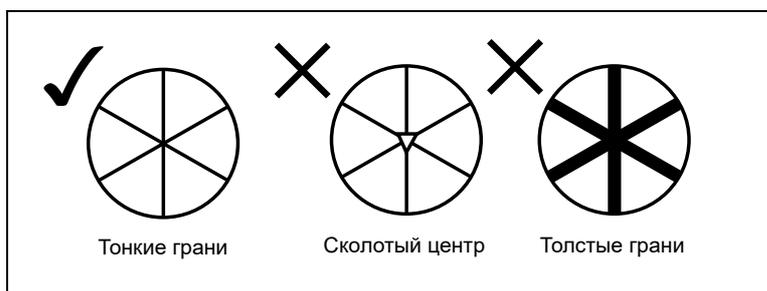
Поскольку тахеометр является чрезвычайно чувствительным инструментом, при наличии нескольких отражений на поверхности призмы точность измерения может значительно снизиться.
