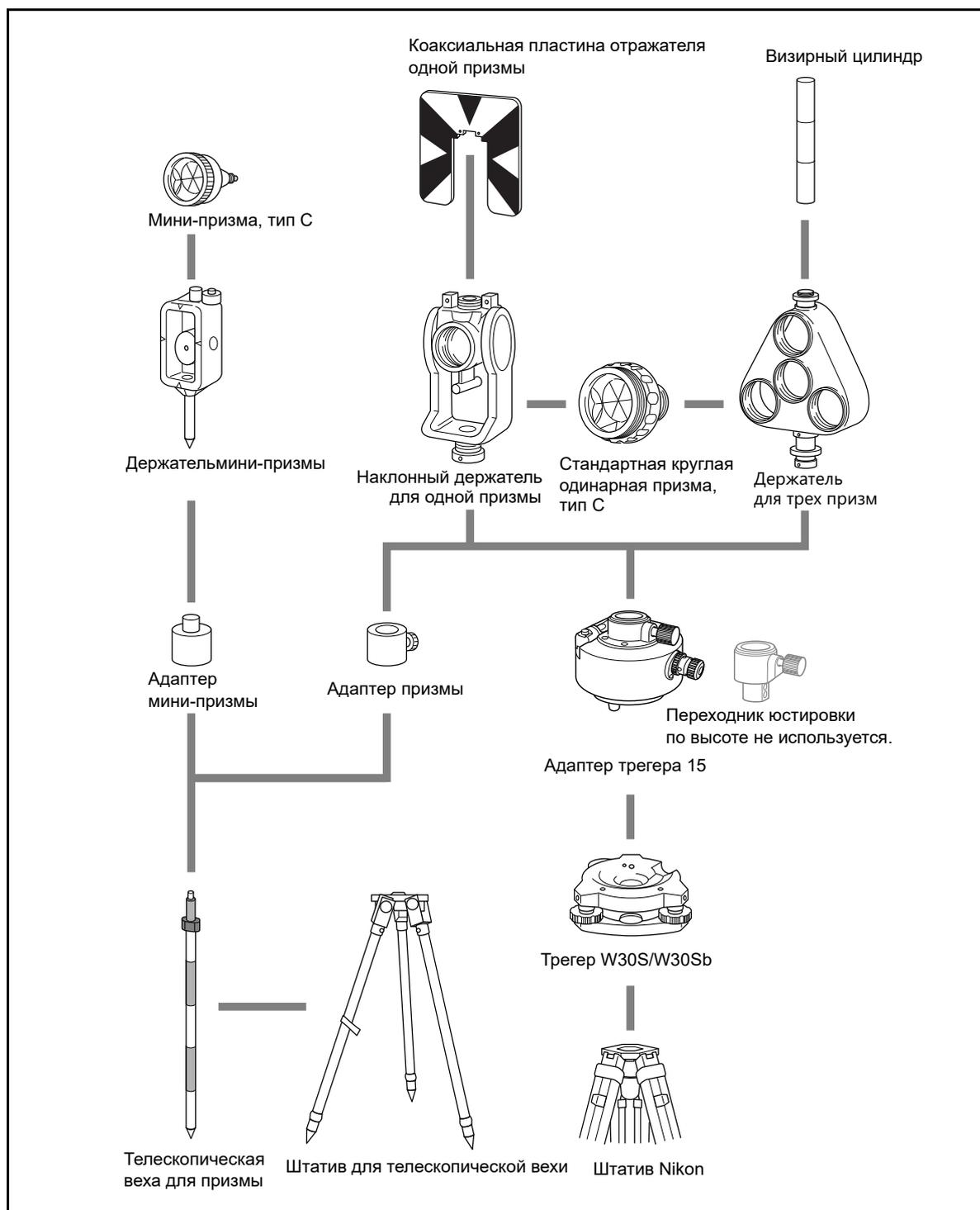
Рисунок 5.2 Компоненты призмного отражателя
