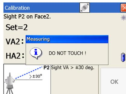
Значение допуска в показании угла для каждого направления составляет 10". Для поддержания точности инструмента необходимо выполнять измерения очень внимательно. Если значение dHA в одном направлении составляет более 10", отображается сообщение об ошибке, и необходимо повторно измерить все три набора точек.
