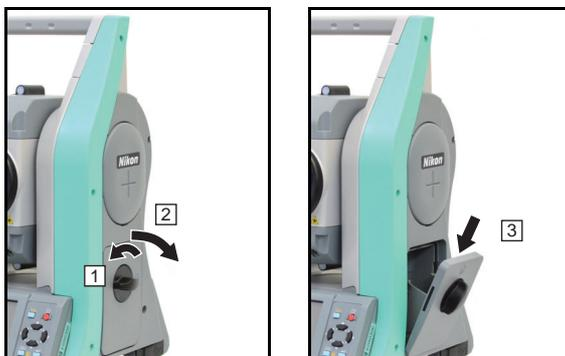
1. Поверните ручку фиксатора батарейного отсека против часовой стрелки и откройте крышку батарейного отсека.
