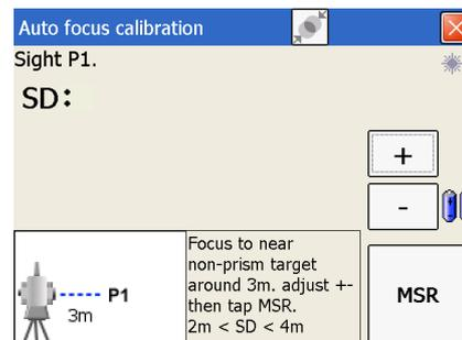
**Примечание.** Кнопка «ИЗМ» активируется после нажатия кнопки «+» или «-» и отключается после перемещения фокусировочного кольца. При нажатии кнопки «ИЗМ» запускается измерение расстояния в точном безотражательном режиме.
