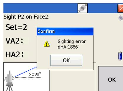
После выполнения трех наборов измерений при КЛ/КП инструмент рассчитывает параметр наклона горизонтальной оси вращения и обновленное значение АСН (среднее по каждому набору).
