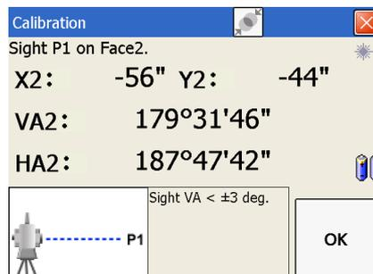
После завершения измерения при КП отобразятся значения трех параметров.
