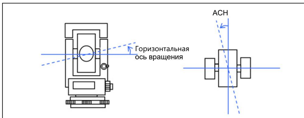
Поскольку значение компенсации изменяется в соответствии с вертикальным углом, при включении компенсации возникает небольшое перемещение по горизонтальному углу, даже при фиксации винта наводки.
