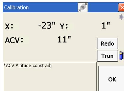
4. Для перехода ко второму шагу (компенсации наклона горизонтальной оси вращения) нажмите кнопку «Цапф.».
