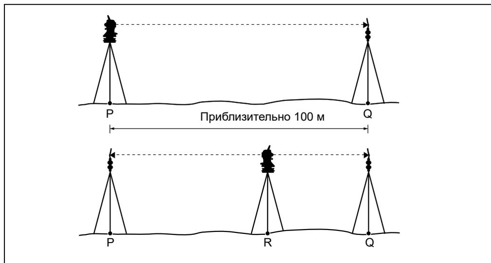
Для проверки постоянной инструмента:
