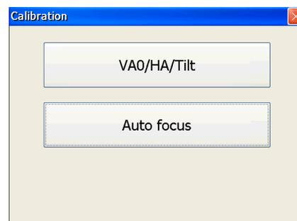
1. Наведите инструмент на безотражательную цель на расстоянии 2–4 м и выполните фокусировку вручную с помощью фокусировочного кольца. Затем нажмите кнопку «+» или «-» для точной настройки фокусировки, а после завершения точной настройки нажмите кнопку «ИЗМ».
