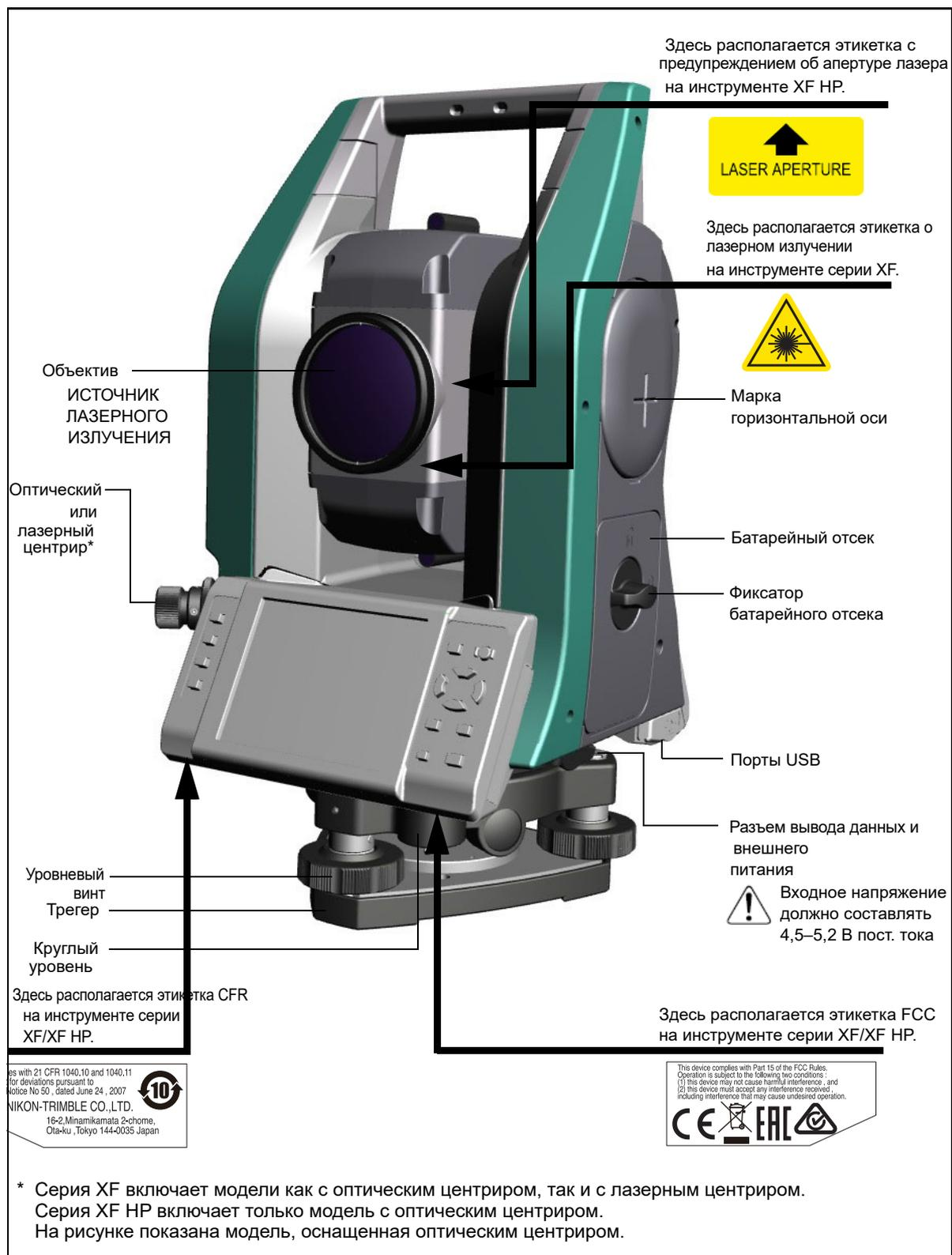
Рисунок 1.2 Тахеометр серии XF/XF HP — КП
